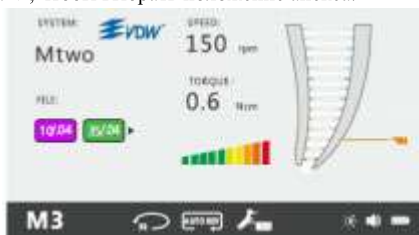
Рис. 29 Выбор положения апекса при включении функции "DR'S CHOICE"
